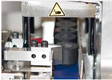
Am Ende der Vereinzelung wird der Gummipuffer ausgehoben und in die Waagerechte gedreht. Ein Roboter bringt das Gegenstück in Position.
