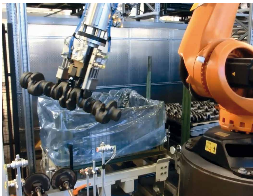
Roboter greift Kurbelwelle aus Gitterbox.
