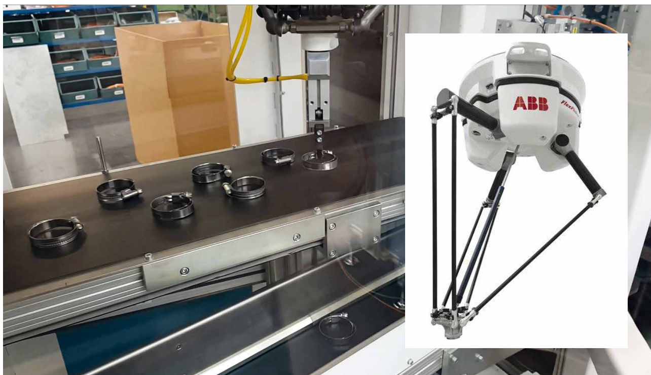
Roboter greift Rohrschellen vom laufenden Band.
