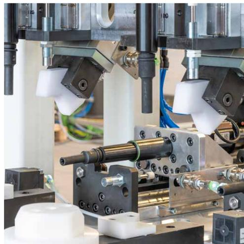
*Zwei pendelnde Anpressformstücke gewährleisten die perfekte Anlage der beiden zu verschraubenden Bauteile.*
