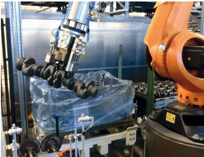
Roboter greift Kurbelwelle aus Gitterbox.
